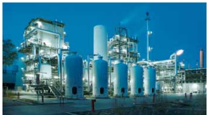
↳ In einer Pilotanlage erprobt Linde die Gewinnung von Wasserstoff aus Glycerin.
